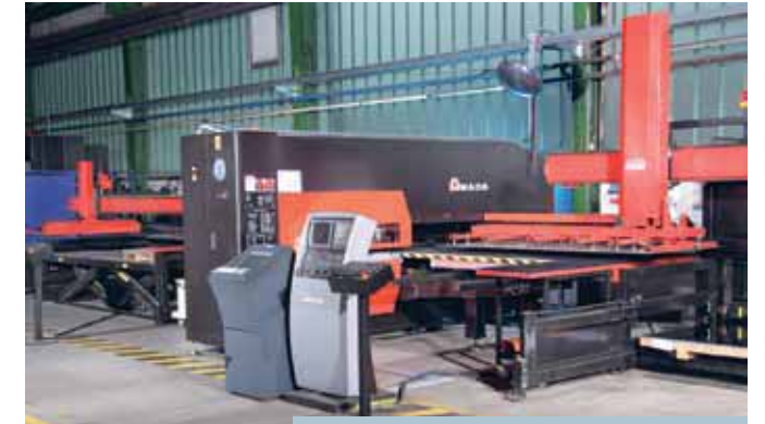
Weiterverarbeitung auf Stanz-Nibbel-Laserzentren mit mechanisierten Be- und Entladestationen | Further processing in the punching and nibbling laser centres with mechanised charging and discharging stations | Parachèvement sur les centres de poinçonnage et de grignotage avec stations de chargement et de déchargement mécaniques
