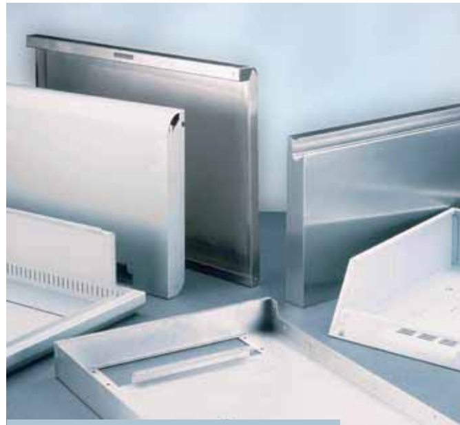
Diverse Kantteile, gefertigt auf Salvagnini P4 I Various folded parts, made in the Salvagnini P4 I pièces diverses pliées, fabriquées sur la Salvagnini P4
