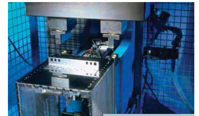
Hochfeste Verbindungs- und Füge-technologien, u.a. im Clinchverfahren | High strength connection and fitting technology, like clinching process | Technologie d'assemblage performant, entre autres le clinchage
