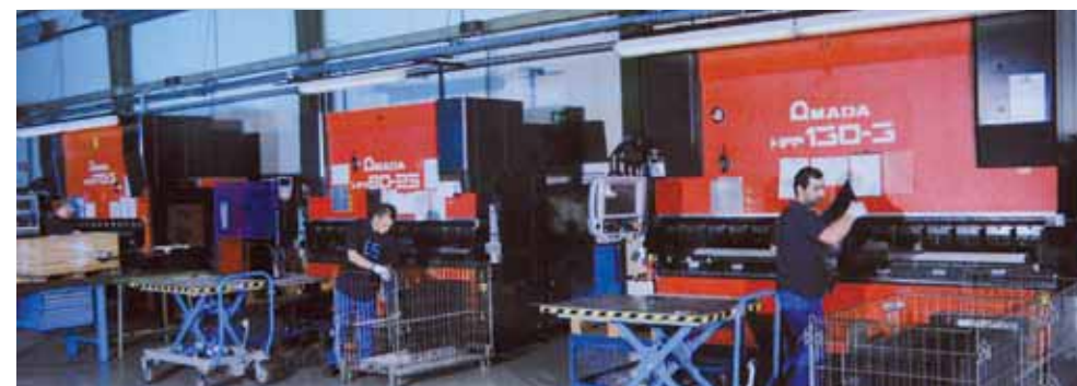
High-Speed Abkantpressen mit Abkantlängen von bis zu 6000 mm I High-Speed mechanical press brakes with folding lengths of up to 6000 mm I Presses plieuses à grande vitesse avec longueurs de pliage jusqu'à 6000 mm.
