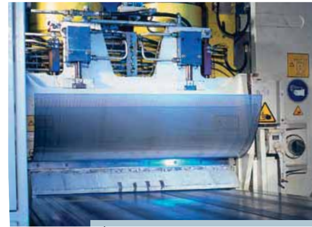
Herstellung von Lochblechen auf einer Hochgeschwindigkeits-Perforierpresse | Production of perforated plates in a high speed punching press | Fabrication de tôles perforées sur une presse longue à haute vitesse
